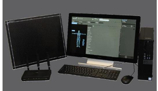
O PaxScan 4336W v4 é um detector de painel plano sem fio projetado para sistemas radiográficos digitais. A 4336W v4 ajusta bandejas padrão de 14" x 17" e sua comunicação sem fio permite a fácil migração entre as exposições livres, na mesa e no Bucky Mural.
